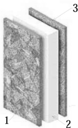
Рис. 2. Структурная изолированная панель. 1,3 – ориентировано – стружечные плиты; 2 – жесткий плитный утеплитель.
