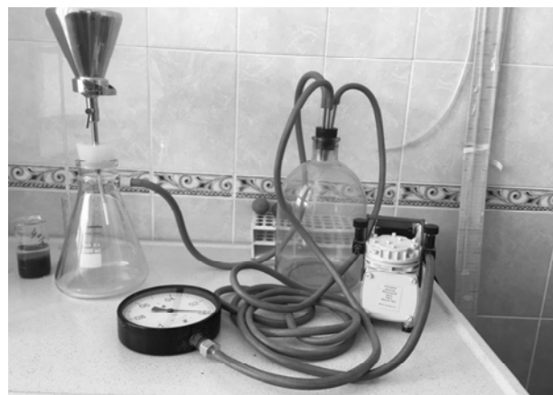
Рис. 6. Схема лабораторной установки мембранной фильтрации 1 – воронка, 2 – мембрана, 3 – сборник фильтрата, 4 – ресивер, 5 – вакуумметр, 6 – вакуум-насос, B – откачка воздуха
